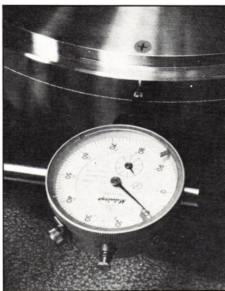
Messung der Exzentrizität des Tellers: Der Ausschlag der Meßuhr an zwei diagonal entgegengesetzten Punkten beträgt 180 \mu\text{m}
