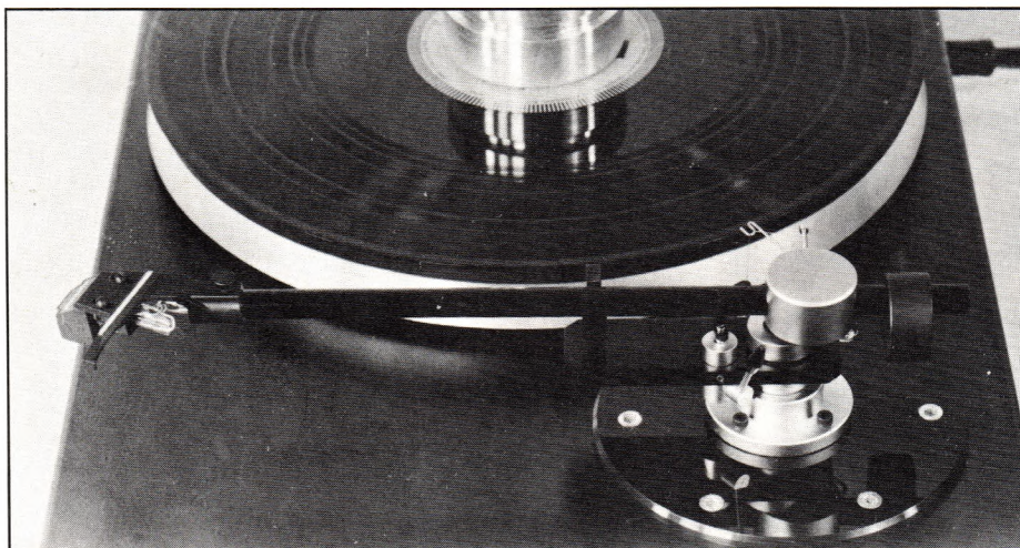
Die Spitzenlagerung des Tonarms mit Tonkabeln und Steckerchen
