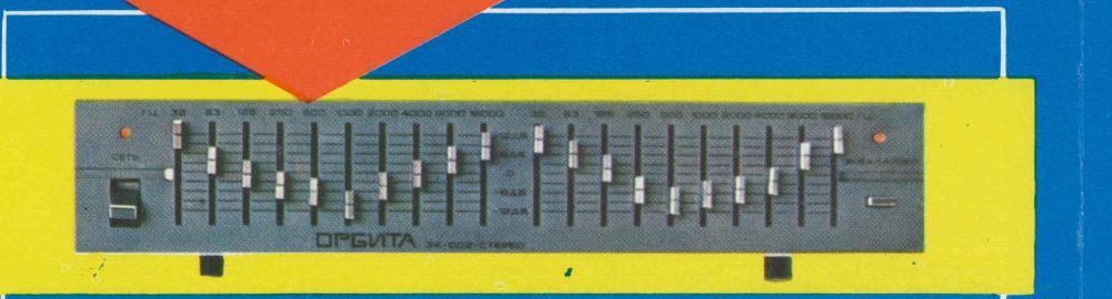
Стереофонический (двухканальный) многополосный октавный регулируемый фильтр предназначен для коррекции амплитудно-частотной характеристики (АЧХ) звуковоспроизводящего тракта радиокомплекса «Орбита-002», а также магнитофонов, тюнеров, электронных музыкальных инструментов и других источников низкочастотных сигналов напряжением 250..1000 мВ.
