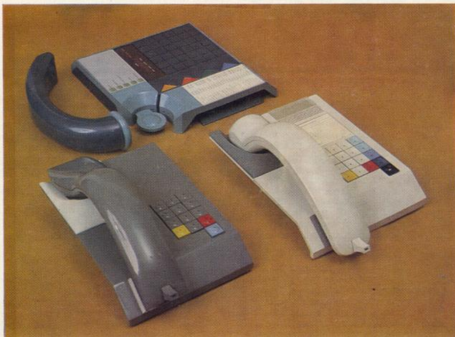
1. Ряд телефонных аппаратов «Каскад» с кнопочной тастатурой. Проекты разработаны для массового выпуска на основе автоматизированного производства. В них предложены принципиальные формообразующие и конструктивные элементы, различные комбинации которых позволят обеспечить ассортиментное разнообразие продукции. Дизайнеры: А. Г. МАРЕЕВ, А. М. ТАУБЕ, Я. В. ГОССЕН, Ю. М. САВИН
