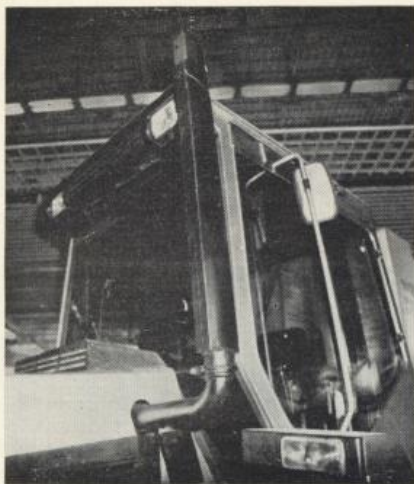
5. Кабина и выхлопная труба. Для водителя труба находится как бы в тени угловой стойки и потому — вне поля зрения
