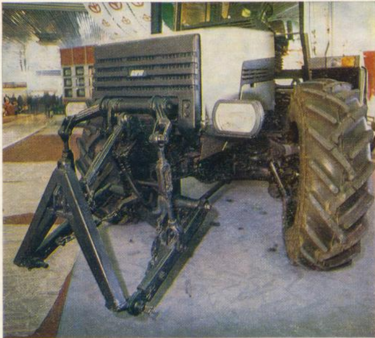
3. Отличительный элемент интегрально-го трактора — механизм передней навески перед моторной группой
