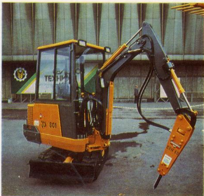
9. Микроэкскаватор мод. 801 со сменными рабочими органами для мелких работ на фермах, в коммунальном хозяйстве, в строительстве. Фирма JCB, Великобритания
