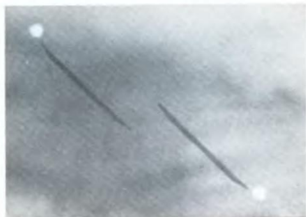
Рис. 6. Электронная микрофотография двухэмиттерного транзистора, левый эмиттер которого имеет электрическое смыкание с коллектором ( \times 1000 )
