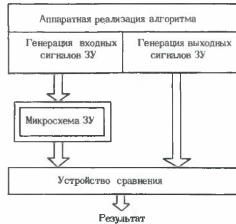
Рис. 1. Функциональный контроль ЗУ с алгоритмической генерацией сигналов
