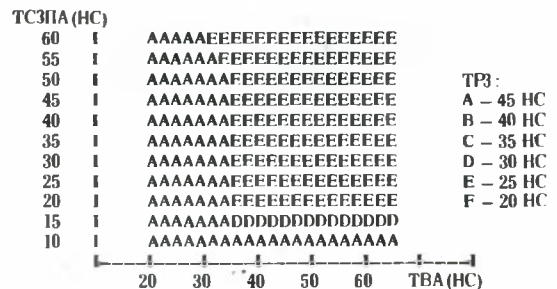
Рис.12. Диаграмма двухмерной алгоритмической (а) и трехмерной (б) области работоспособности ОЗУ
