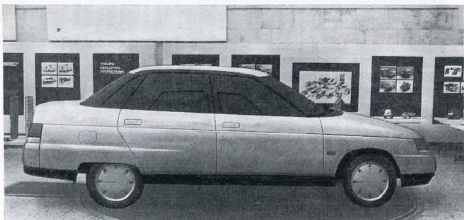
2. Базовый автомобиль семейства ВАЗ-2120. Макет, пластилин. Ведущий дизайнер В. ЯРЦЕВ
