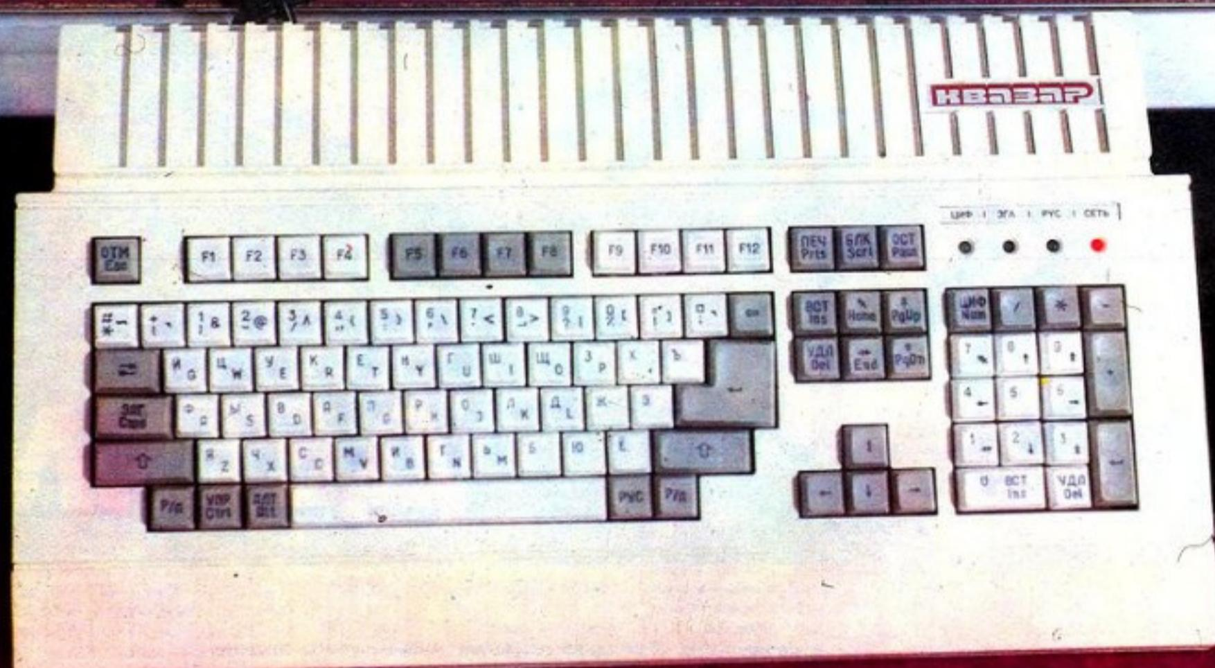
С помощью персонального компьютера «Квазар-86» можно изучать программирование, выполнять научно-технические расчеты, составлять различные обучающие и игровые программы. Программное обеспечение компьютера включает: программу В 105, размещенную в ПЗУ; интерпретатор языка бейсик; пакет игровых программ, размещенных на магнитной ленте.
