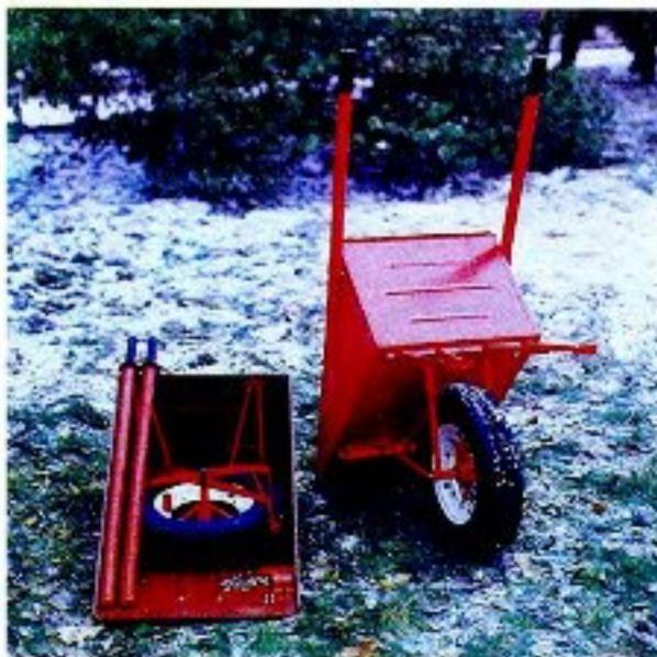
Тележку можно быстро переоборудовать из двухколесного варианта в одноколесный. Быстро съемные борта позволяют увеличивать объем кузова в два раза [пожелание шведских фермеров].
