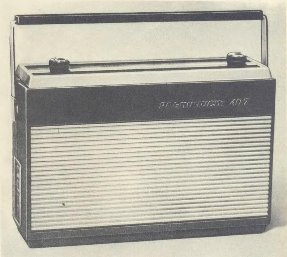
Транзисторный радиоприемник IV класса «Альпинист-407» представляет собой модернизированный вариант серийной модели радиоприемника «Альпинист-405» (органы управления и шкала с фронтальной стороны панели корпуса перенесены на верхнюю часть, изменена отделка корпуса).
