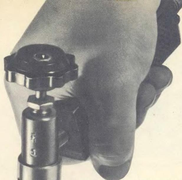
Назначение газовой горелки, освоенной в Москве, то же, что и паяльной лампы, но в отличие от последней она легка, безопасна и удобна в работе. У горелки хорошая направленность пламени с более высокой температурой (до 1200°).
