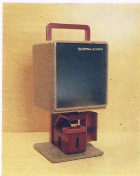
1. Диапроектор «Диарир-универсал» со встроенным экраном. Проецирует изображение на встроенный и выносной экраны. Упрощенная конструкция диамагазина не требует использования специальных кассет. Все операции по настройке изображения на выносном экране производятся с помощью специальной отклоняющей системы, которая исключает необходимость наклона и поворота самого диапроектора. Дизайнер А. В. ВЕРЕМЕЙЧУК
