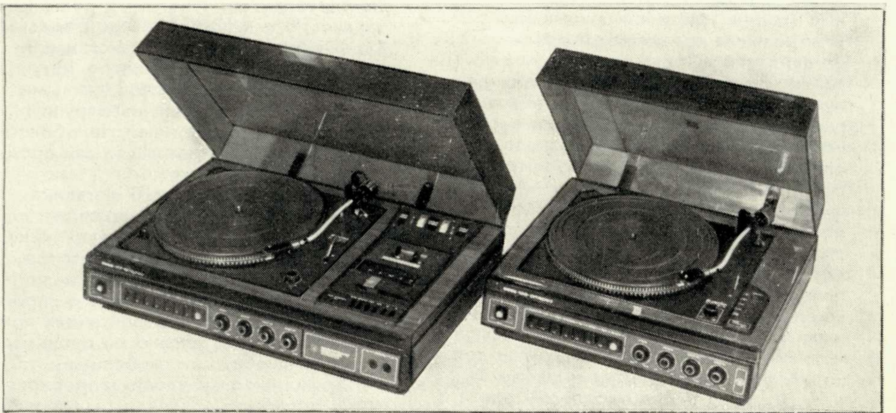
7. «Вега-117-стерео». Комбинированное устройство, созданное на базе электрофона «Вега-108» (справа)
