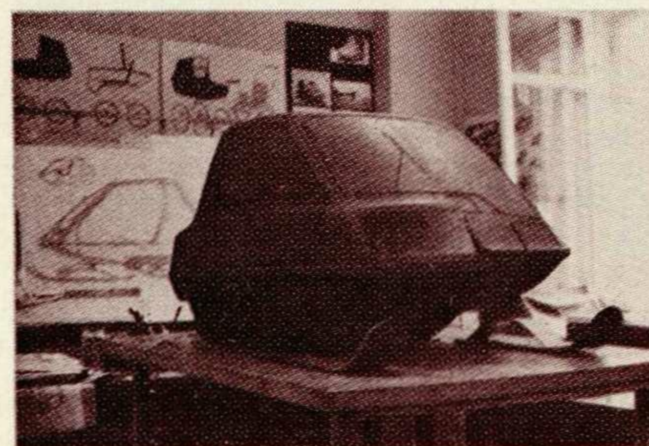
1. а, б, в. Поисковый макет снегохода. Пласталин. Масштаб 1:2,5.
