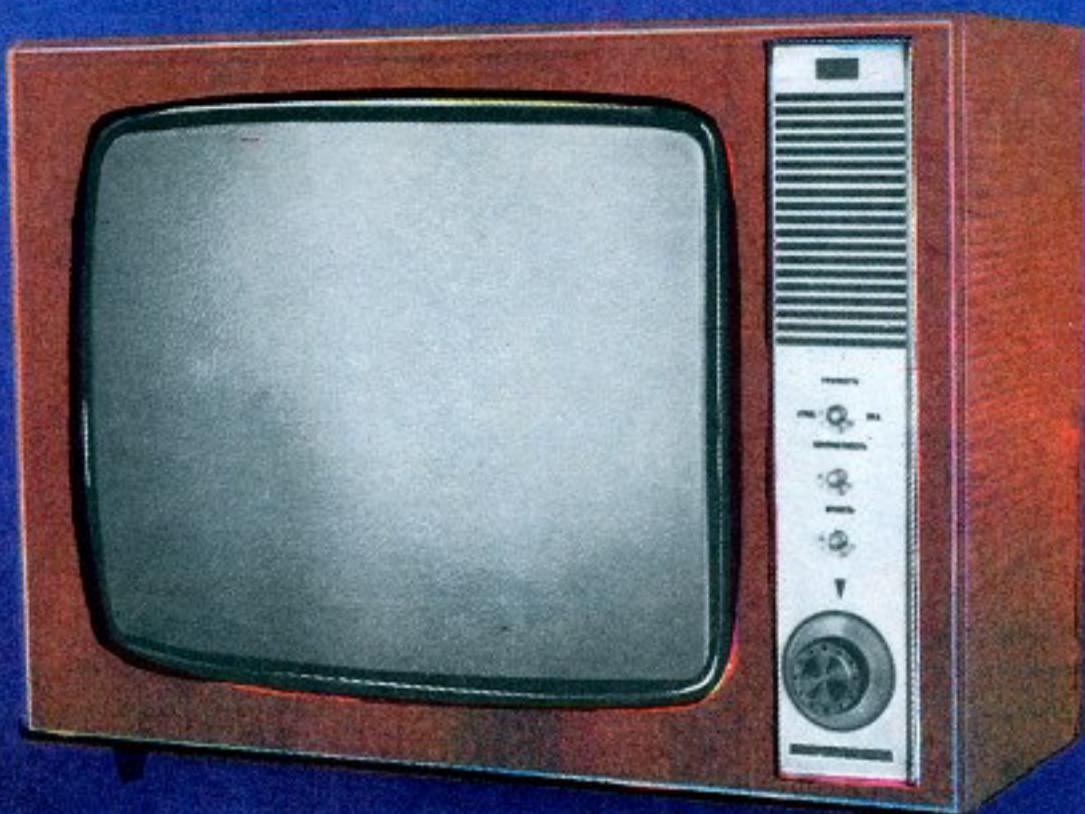
«Каскад-203» (УЛТ-61-II-4) — унифицированный телевизор II класса с размером экрана по диагонали 61 см. Прием телевизионных передач ведется в метровом диапазоне волн. Кроме того, в нем предусмотрена возможность установки блока дециметровых волн СКД-1.
