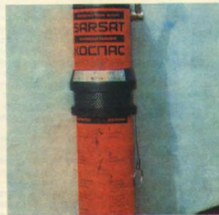
4. Рекламная, информационная и функциональная графика на корпусе радиобуя выполнена на двух языках — русском и английском, а также в виде пиктограмм
