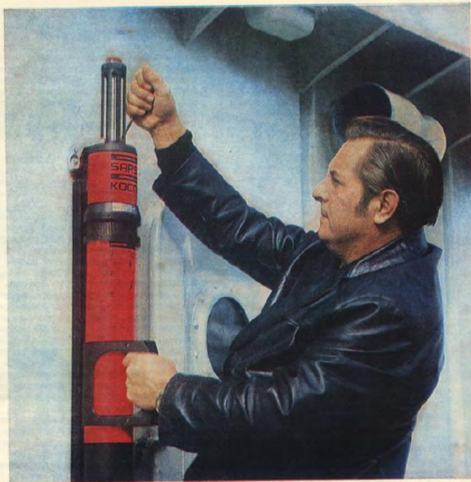
1 Ввод в действие аварийного радиобуя, укрепленного на переборке рулевой рубки. Дизайнеры: В. П. ПРОХОРЕНКОВ, И. Е. БАБИКОВ, ВНИИТЭ
