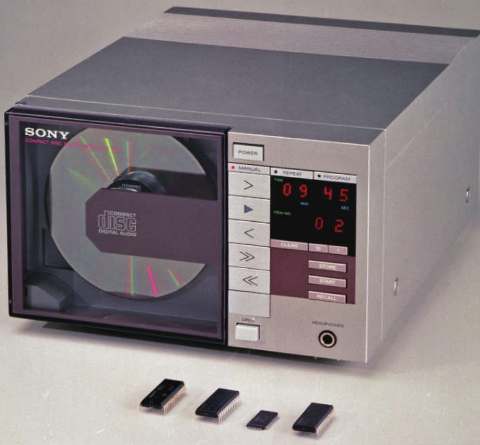
1981年に発表したソニーの試作機。そのずんぐりした筐体から『ゴロンタ』と呼ばれた。この正立型のローディングを見て、「ソニーがこの方式を選ぶなら」と各社の1号機は正立型が多かったが、ソニーの市販1号機、CDP-101はトレイローディング方式だった。それを見た他メーカーの開発者の中には「ソニーに騙された」（正立型の方がローディングもサーボも面倒だったため）と思った人もいたとか。しかし当の中島氏は各社の1号機を見て「しまった、タテ型の方が良かったのか」と思ったという。ちなみにゴロンタの前に並べられたLSIは、サーボやDAC等主要なICはこの4つのLSIに集積された、というアピールだった。（写真提供・ソニー）
